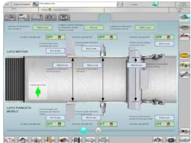
Gracias al nuevo sistema de guías motorizadas, el ajuste de la conicidad en la entrada PCR es ahora mucho más sencillo. La interfaz de la PCR dispone de una página específica en la que se muestran las posiciones de los actuadores y su funcionamiento. El sistema garantiza siempre una perfecta carga y densidad de los bordes de la placa
