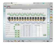
Il nuovo dispositivo è capace di monitorare e regolare il caricamento della polvere dall'APB al nastro della linea Continua+, in modo da ottenere sempre una perfetta stratificazione e densità della lastra. Un vero passo avanti per l'efficienza della linea.
