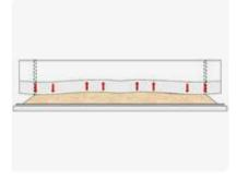
Una combinazione di attuatori elettrici gestiscono, in tempo reale e grazie ad un software sofisticato, il caricamento della polvere durante la produzione, senza necessità di ulteriori fermate della linea.
